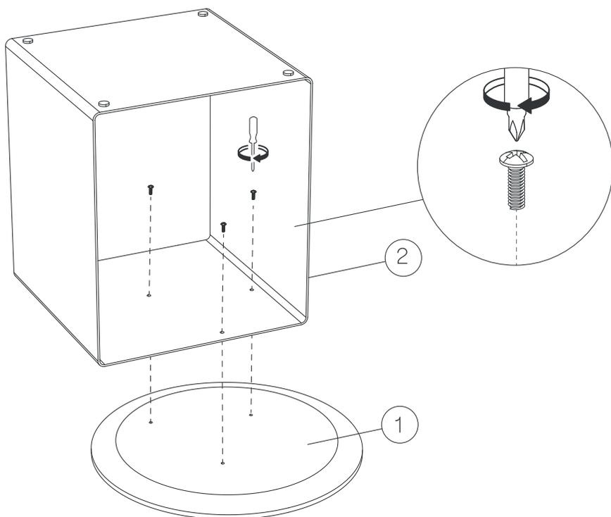
Asegúrate de tener suficiente espacio para realizar el montaje y coloca la pieza (1) con los agujeros hacia arriba sobre una superficie suave. Haz coincidir la estructura (2) sobre los agujeros y enrosca los tres tornillos. Búscate un aliado para este montaje, ¡cuatro manos hábiles trabajan mejor que dos!
